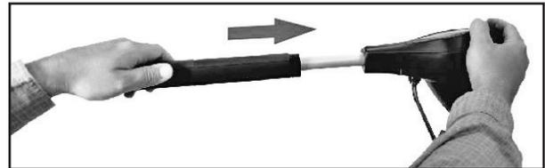
**⚠ MISE EN GARDE!** Avant de travailler sur le propulseur électrique, assurez-vous que les câbles de la batterie ne sont pas reliés à la batterie.
